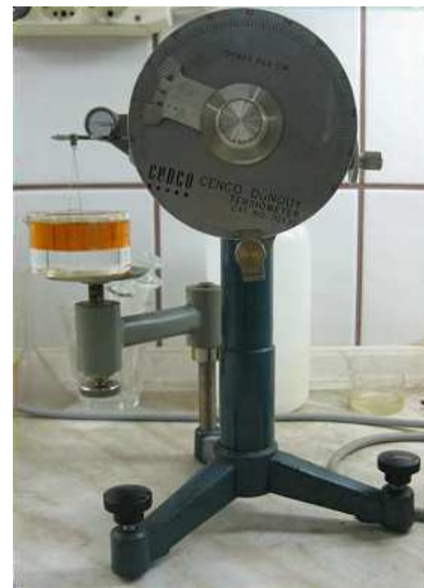
Fig. 2: Tensimeter Cenco du Nouy
