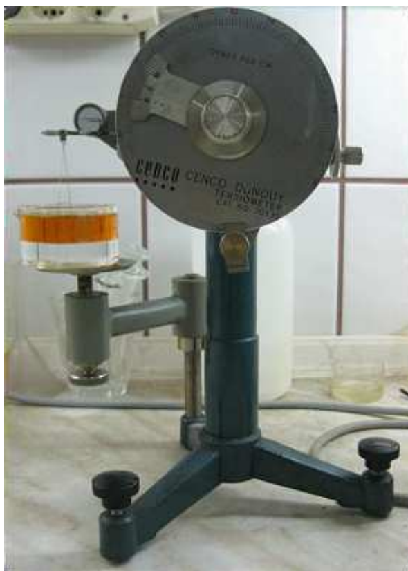
Fig. 2: Tensimeter Cenco du Nouy
